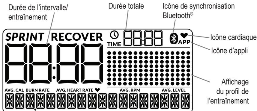
résistance, le profil de l'entraînement indique le niveau de résistance. La console adaptera le niveau de résistance pendant l'entraînement.
